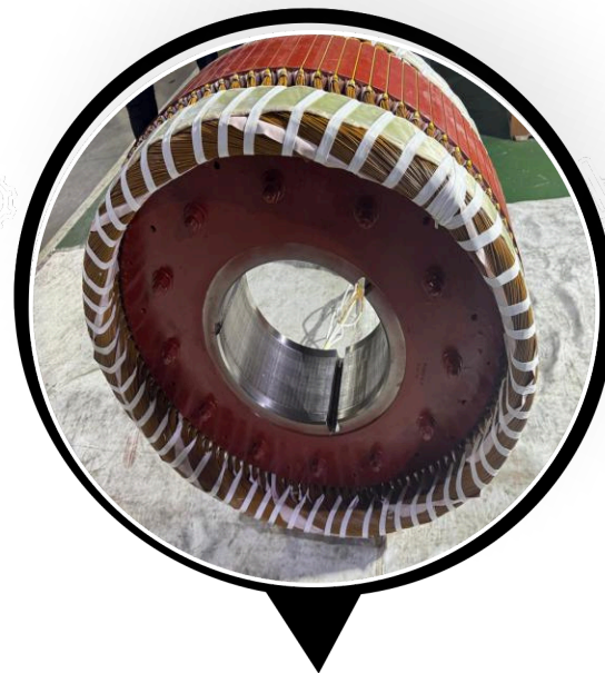
BOBINADO Rotor Excitatriz Motor 7.000 kW.
