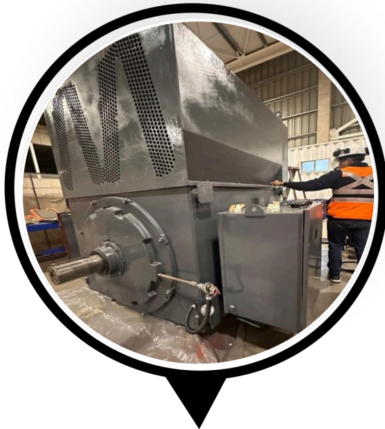
MANTENIMIENTO Motor de Anillo Rozante 1.000 kW.
